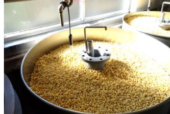
一晩で大豆は約1.8倍の重さに。1タンクで納豆6800個分。水は水道水ですが、多摩川の上流から取水しているため水質は良好。さらに工場内でセラミックフィルターに通すことで水分子が小さくなり、大豆への吸水が高まります。
