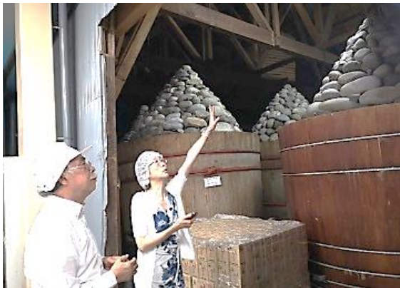
「桶は吉野杉を厚く削って乾燥させたもの。160~170使っていて、空になったら次の仕込まで付着菌を防ぐために味噌をつけたままにしておきます。桶屋さんが2020年に廃業するので今年も来年も注文します」と語る浅井社長。各桶には原料や仕込年月日や出荷可能時期を明記した仕込明細書がついています。
