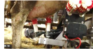
搾乳ロボットは乳房の洗浄、搾乳だけでなく配合飼料の給餌も担っています
